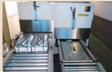
洗浄機 （投入口と搬出口）
