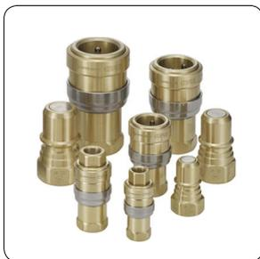
迅速流体継手「カブラ」は、空気・ガス・水・油など様々な流体の配管を素早く、確実に接続・切り離しできる製品です。工場内の各種配管、油空圧機器、半導体製造装置、燃料電池（車両の水素ガス充填用〈写真左〉）など産業用から家庭用まで、25,000種類にもおよぶ製品群がさまざまな分野で使用されています。名実ともに世界トップクラスのシェアを誇るカブラですが、さらに環境対応製品（ゼロスピルカブラ〈写真右〉）など、従来と異なる用途・分野にも積極的に取り組んでいます。
