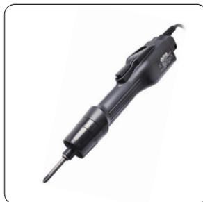
機械工具は、鋼材の穴あけ、研磨、剥離など各種金属の加工用製品と組立工場などのねじ締め作業に使用されている電動ドライバを扱っています。環境配慮製品のMLG-70（写真左）は、小型軽量を追求し、30%の軽量化（当社従来品比）を実現、新素材ブレードの採用でエアモータの長寿命化を図っています。また、ブラシレスデルボ（写真右）は、ブラシレスモータの採用により、高速回転と出力トルクの高効率化、長寿命化を実現しています。
