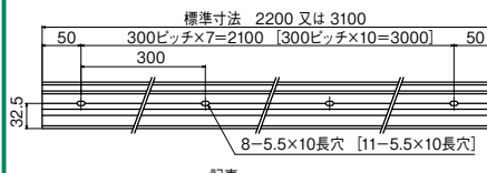
レール：アルミ型材（アルマイト処理） ※断面図は拡大して表示しております
