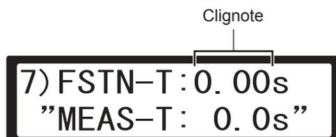
**2 À l'aide d'une pièce et d'une vis, faites tourner la visseuse électrique vers l'avant à une faible vitesse constante pour effectuer le serrage et mesurez le temps de serrage de la vis (MEAS-T)**
